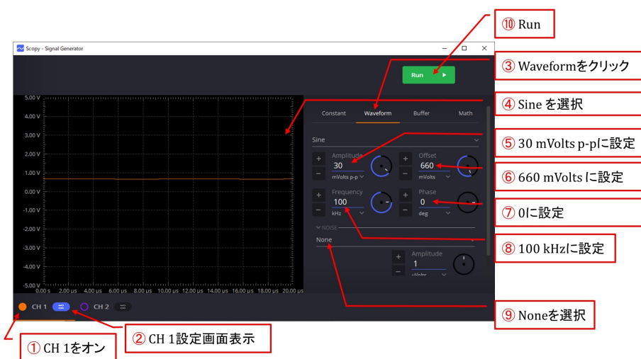
図 A.6: 正弦波形測定実験における関数発生器の設定
