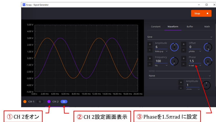
図 D.4: 位相差 \pi/2 の波形発生実験における関数発生器の設定
