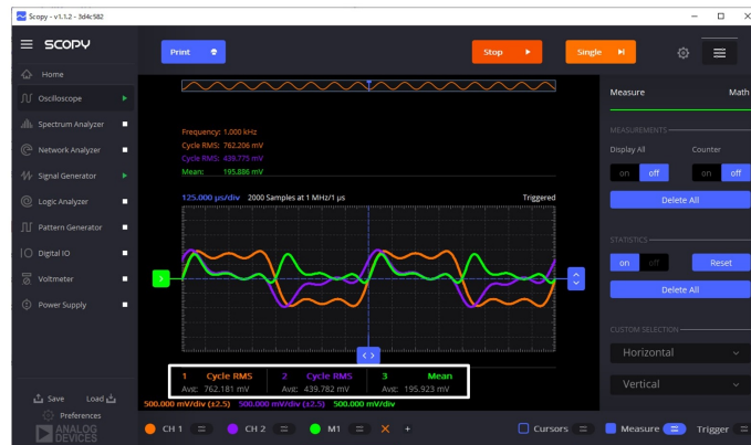
図 D.120: 第 5 高調波までの矩形波を印加した場合の R - C 回路の有効電力
