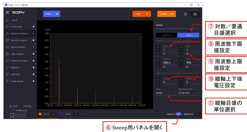
図 B.40: スペクトル解析器 (Spectrum Analyzer) の設定 (Sweep 設定)
