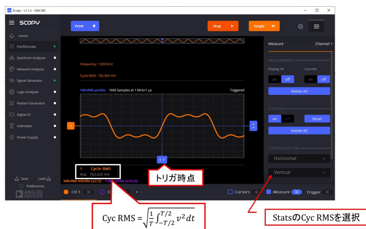
図 D.116: 実効値の計測 (オシロスコープの計測 (Measure) 機能を利用する方法)
