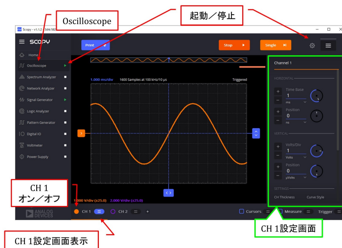
図 B.20: オシロスコープの選択と起動/停止, CH1 のオン/オフと設定画面表示の各ボタン
