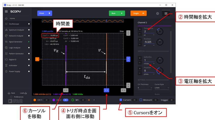
図 D.11: 位相差測定のためにカーソルを利用
