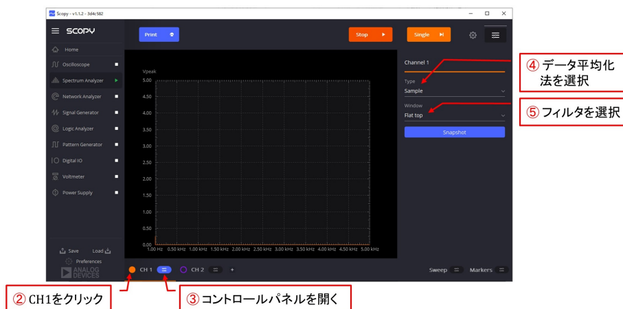
図 B.39: スペクトル解析器 (Spectrum Analyzer) の設定
