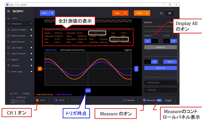
図 B.28: 計測 (Measure) の設定
